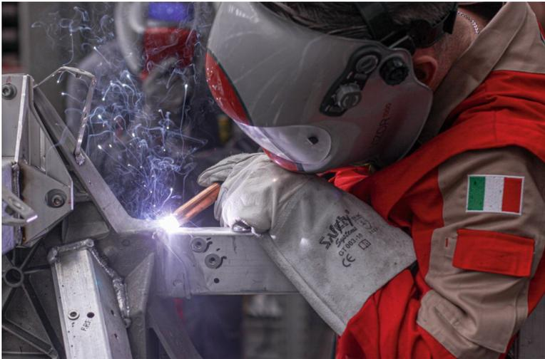
Der CB-392 Schweißer ist ein synergistischer einphasiger Wechselrichtergenerator, **gepulst und doppelt gepulst**, für das kontinuierliche Drahtschweißen von MIG MAG, der verzinkte Blech, hochhohmige Stähle und Aluminium schweißen und hartlöten kann.
