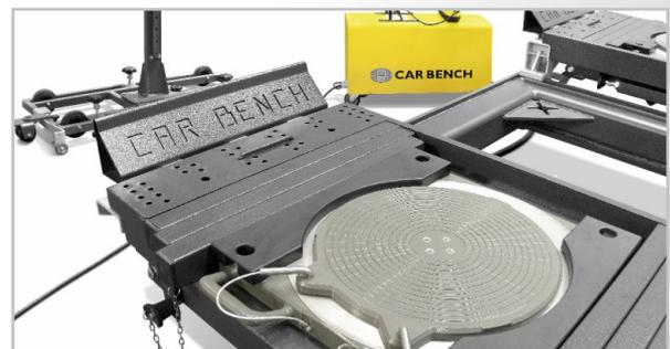
PLACAS GIRATORIAS DE ALINEACIÓN DE RUEDAS INTEGRADAS EN LAS CORREDERAS LATERALES EN 4 UBICACIONES
