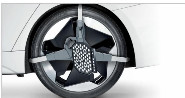
SYSTÈME DE SERRAGE AVEC CENTRAGE AUTOMATIQUE ÉVITE TOUT DOMMAGE À LA JANTE
