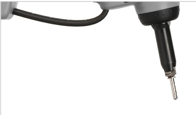
Das Festhaltemundstück hält den eingesteckten Niet durch Federkraft in jeder Position sicher fest. Somit kann das Setzgerät mit dem eingesteckten Niet in jeder Lage, auch nach unten, problemlos in das Bohrloch eingeführt werden ohne herauszufallen. Festhalte-Mundstücke sind in verschiedenen Größen erhältlich.
