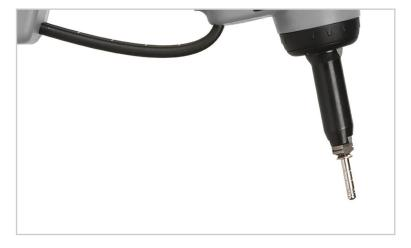
Grâce à l'embout de retenue, le rivet inséré reste dans n'importe quelle position grâce à son élasticité. Même dans les processus de rivetage vertical, le rivet est fermement maintenu dans l'outil. Les embouts de retenue sont disponibles en différentes tailles.
