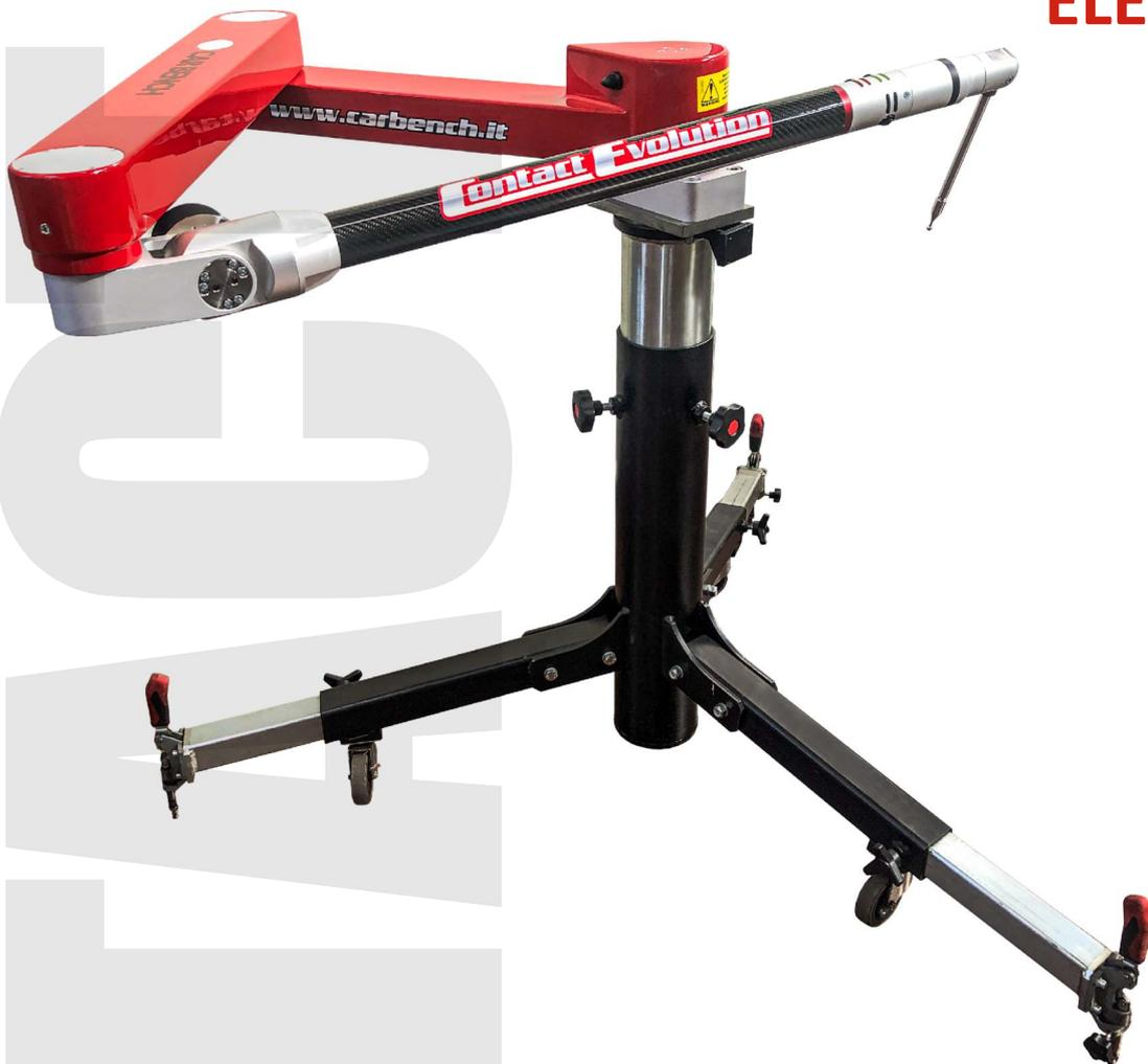
N.3 Positions de verrouillage sans dévisser et recalibrer la sonde
