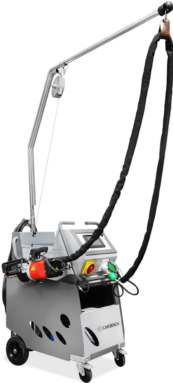
Widerstandsschweißsystem, mikroprozessorgesteuert, vollautomatisch, geeignet für Karosserieanwendungen. Die Schweißsteuerung mit Digitalanzeige und Touchscreen ermöglicht die Anzeige und Steuerung aller Schweißparameter, abhängig von den Werkzeugen, der Art und Dicke der zu schweißenden Bleche.
