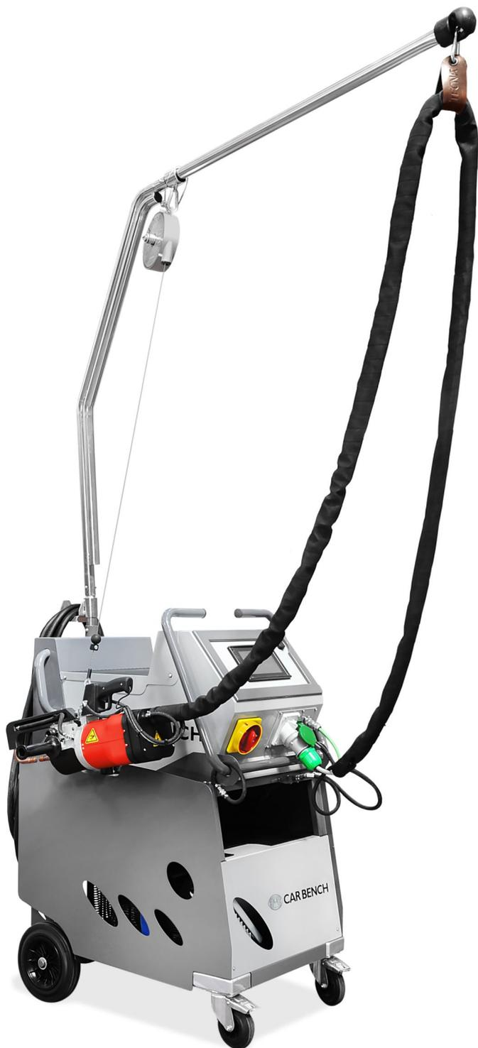
Sistema di saldatura a resistenza, controllato a microprocessore, completamente automatico, adatto per applicazioni in carrozzeria. Il controllo di saldatura a display digitale con touch screen consente la visualizzazione ed il controllo di tutti i parametri di saldatura, in funzione degli utensili, del tipo e dello spessore delle lamiere da saldare.
