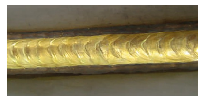
Brazing with CuAl 8 wire
