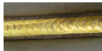
Soldadura fuerte con hilo CuAl 8
