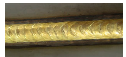
Brazing with CuAl 8 wire
